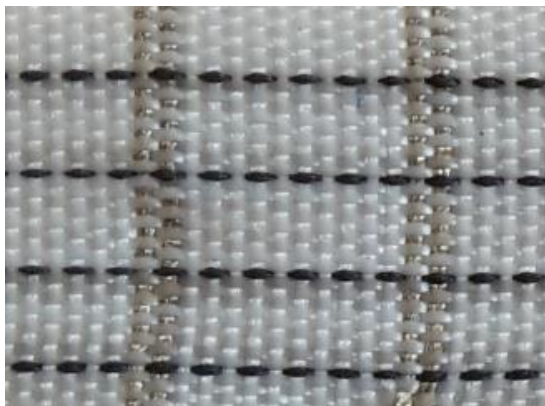
Abbildung 2: Heizgewebe mit integriertem hiTEX-Faden (links) und entsprechendes Wärmebild (rechts)
