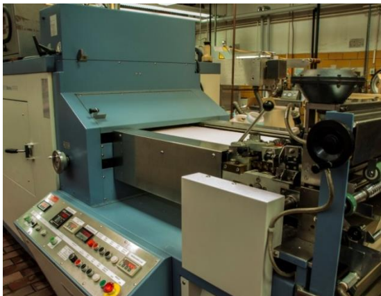
Fertigung eines Textils zur PDI am Spann- Trocken- und Fixierrahmen des TITV Greiz
